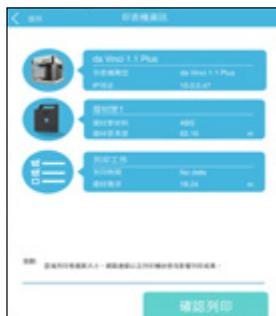
5 Selecione a impressora e confirme as informações da impressora, toque em "Confirm to print" (Confirmar para imprimir), o arquivo será enviado para a impressora e pronto para imprimir.
