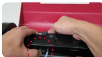
\*Recomendamos o uso de um grampo e outras ferramentas para cortar as pontas dos filamentos para gerar uma ponta afunilada de 45 graus e para endireitar os filamentos para facilitar o processo de carregamento de filamento.
