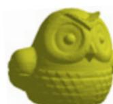
Resultado de digitalização do objeto revestido por pulverização de borracha
